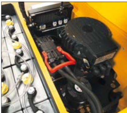
Тяговый двигатель и двигатель подъема с приводом переменного тока
